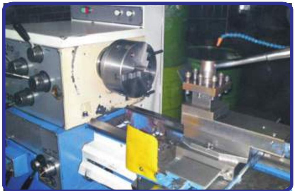
Figura 2 torno paralelo (torre y copa)
